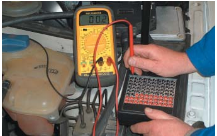
Comprobación con caja de comprobación
