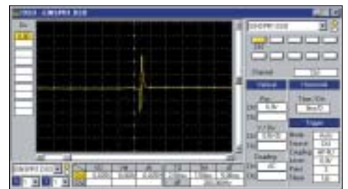
Imagen animada: Válvula de inyección averiada
