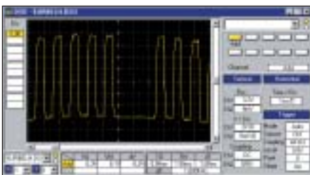
Imagen en vivo transmisor Hall con fallo: dientes ausentes en la rueda dentada
