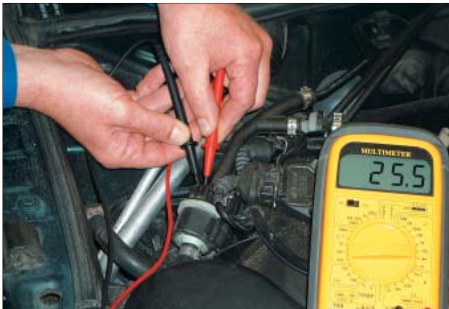
Medición sin cable adaptador
