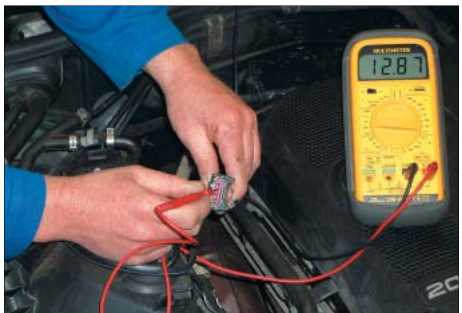
Medición sin cable adaptador
