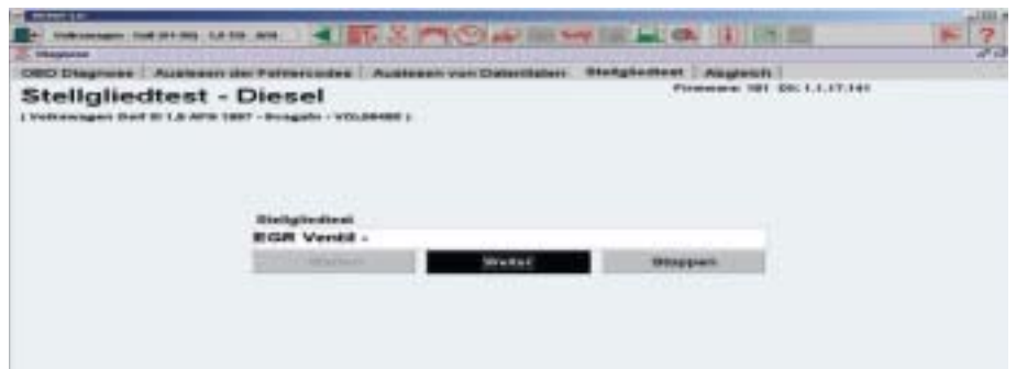
Comprobación del elemento de regulación EGR
