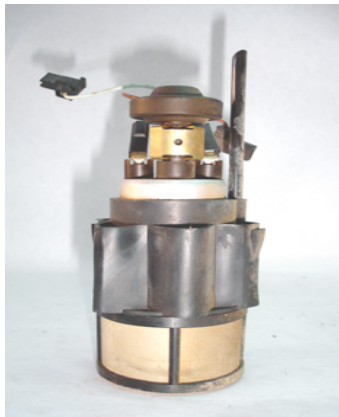
Fig. 134. vista interna de una bomba de gasolina
