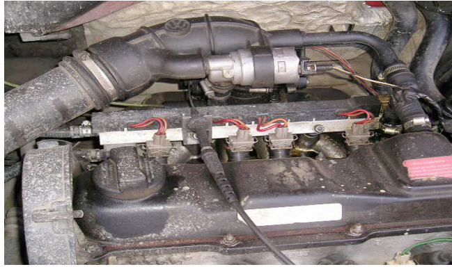
Fig. 140. Barra o Riel de inyectores instalada en el motor
