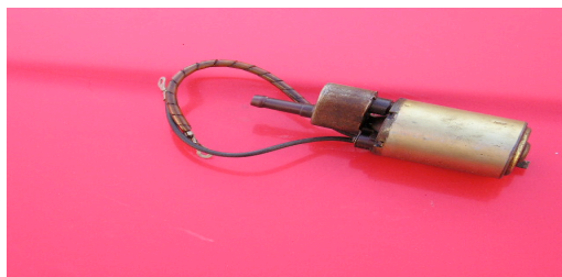
Fig. 136. Pila de bomba de combustible
