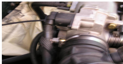
Fig. 126 ubicación de la válvula IAC.
