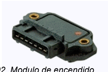
Fig 102. Modulo de encendido
