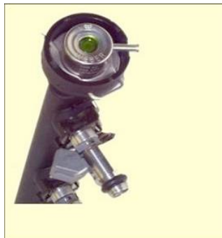
Fig. 139. regulador de presión en la barra de inyectores
