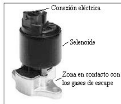
válvula EGR inyección
