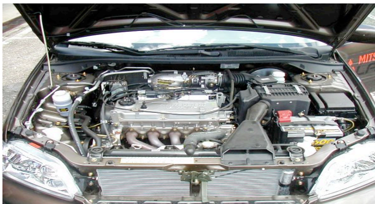
Fig 1. Automóvil con sistema de inyección multipunto
