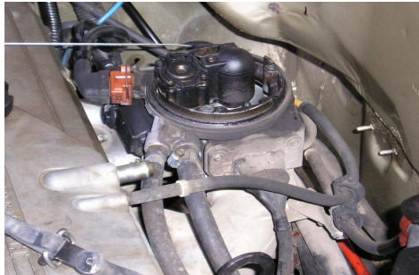
Fig. 62. ubicación del TPS en un Monopunto
