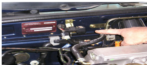
Fig. 59. Ubicación del sensor de presión barométrica
