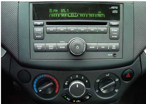
En la figura un tablero con control manual AC
