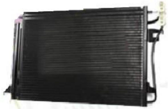
En la figura un serpentín del condensador
