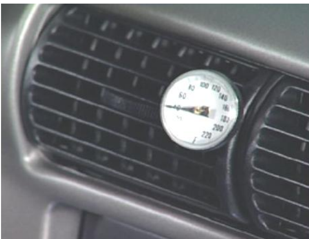
En la figura registro de temperatura de rejilla
