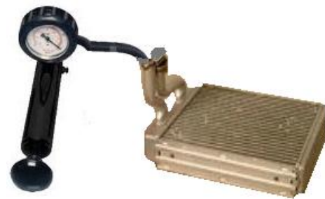
En la figura la prueba del serpentín evaporador
