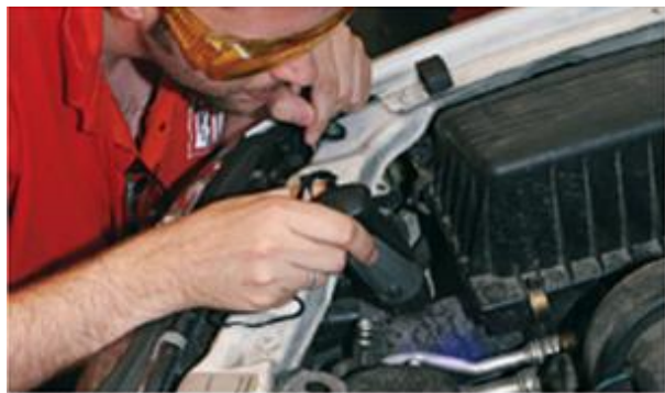
En la figura la detección de fugas de color verde
