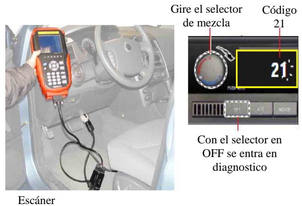
En la figura la lectura de códigos de falla DTC
