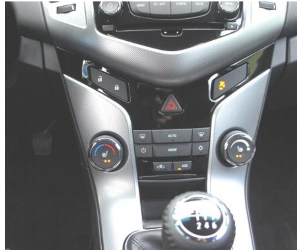
En la figura un tablero con control automático AC
