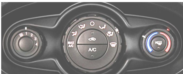
En la figura el selector de modo y modulo HVAC
